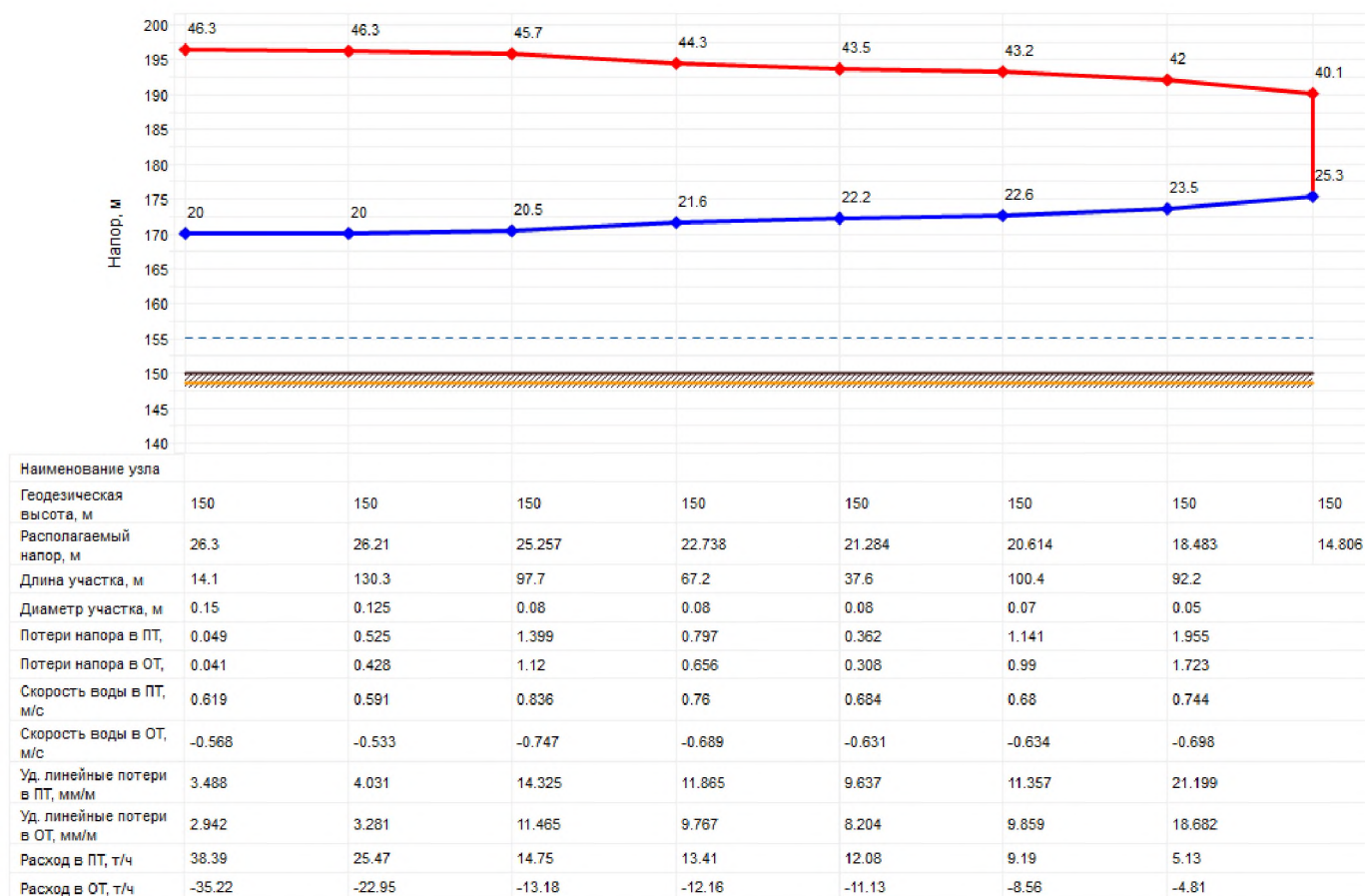
Рисунок 2.9 – Пьезометрический график тепловой сети котельной №3, с. Новошилово, ул. Приозерная, 5А
