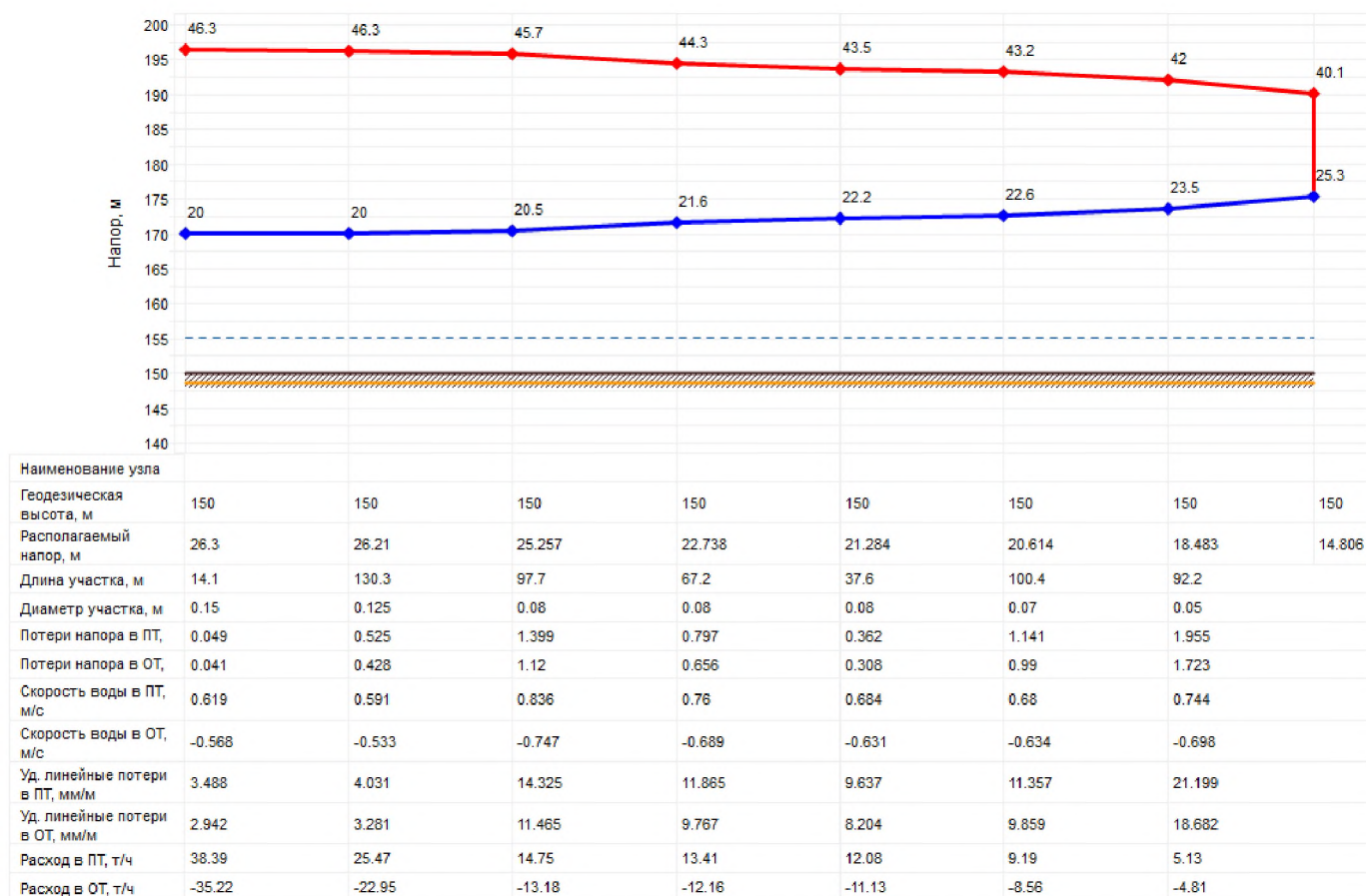
Рисунок 2.15 – Пьезометрический график тепловой сети котельной № 3 с. Новошилово, ул. Приозерная, 5А
